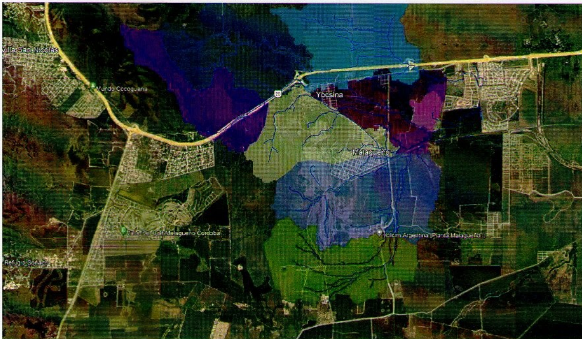
Figura 13: Principales subcuencas y red de drenaje superpuestas a una imagen satelital del terreno y con la ubicación del loteo en estudio.
